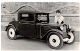
1931 DKW F1 mit Zweitaktmotor und Frontantrieb
